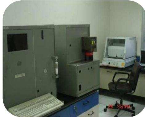
Leco Oxygen Analyzer: R0300 & X-Ray Fluorescence Spectrometer
